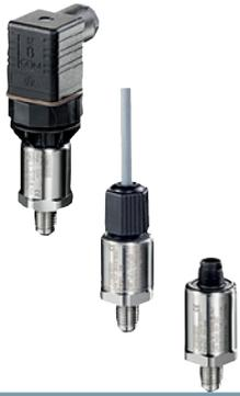
Датчики абсолютного и избыточного давления серии SITRANS P200 - простое и бюджетное решение для задач, не требующих высокой точности (погрешность 0,25%) и перестройки диапазона измерения. Преобразователь имеет выходной сигнал 4...20 мА или 0...10 В.
